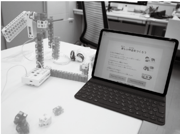
写真4 タブレットでプログラミングして KOOV に転送
