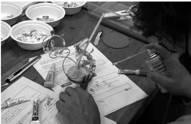
硬化促進剤を吹き付ける
