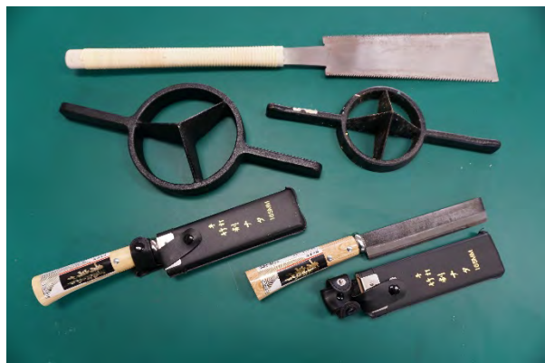
図版4. 竹を加工する道具（上からのこぎり、竹割器、両刃竹割ナタ）
